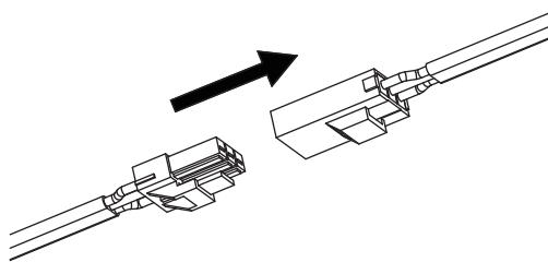
5 器具本体側取付金具の開口部にライトユニットの取付金具を「パチン」という音がするまで押し込んで固定してください。
