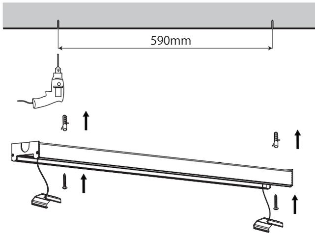
2 電源線、アース線を器具本体の電源用穴から引き込み、端子台へ確実に差し込んでください。
