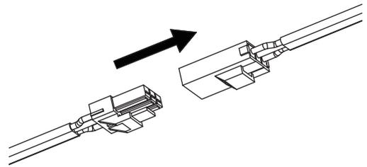
5 器具本体側取付金具の開口部にライトユニットの取付金具を「パチンッ」という音がするまで押し込んで固定してください。
