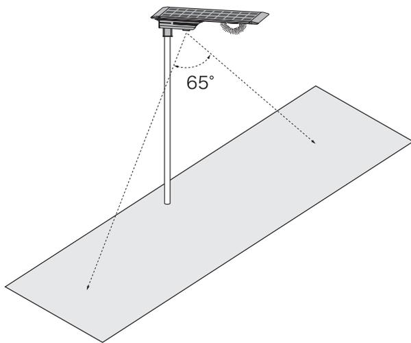
灯具を設置する際、人感センサーを人が通行する動線に向けて設置してください。
