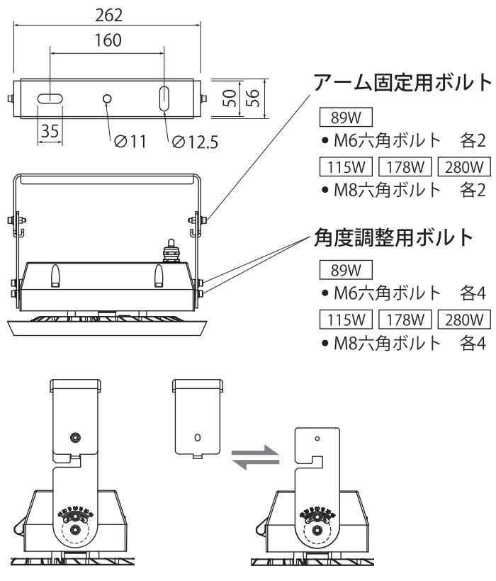
取付けボルト設置図
