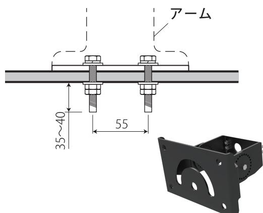
上下の角度調整は、中央のM8ボルトを緩め、周囲のM4穴付きボルトを外し角度調整後、周囲の穴にM4穴付きボルトを挿入し、裏側に歯付きワッシャーとM4ワッシャーとM4ナットで仮固定し、中央のM8ボルトを仮固定してください。
